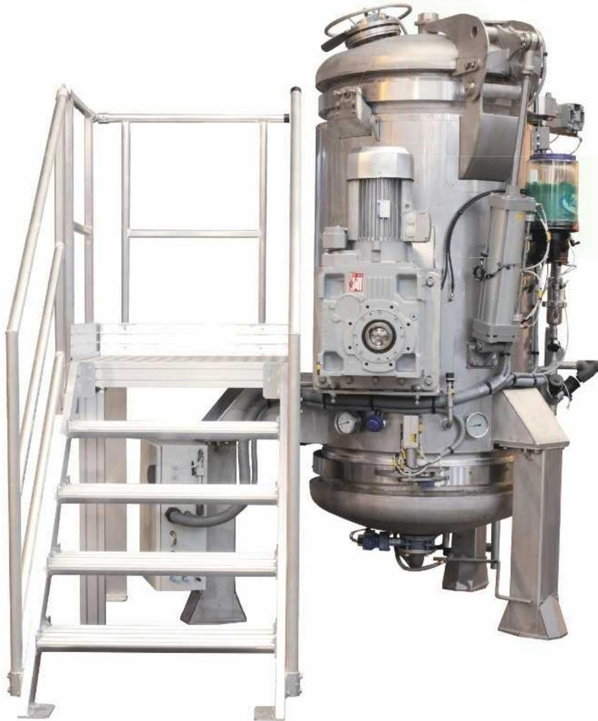
Les déchets contaminés sont introduits dans la chambre supérieure de la machine munie d'un broyeur à haute résistance. Les déchets sont broyés et acheminés, par gravité, vers la chambre inférieure.
