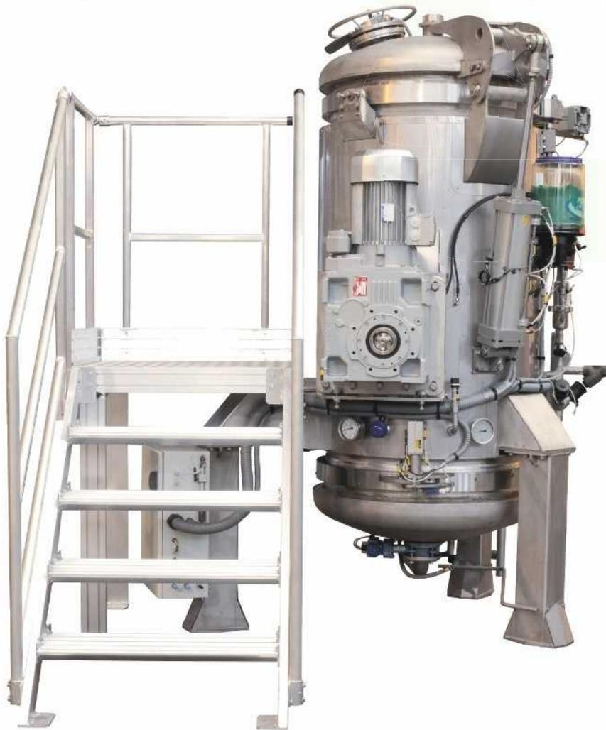
Los residuos contaminados se cargan en la cámara superior donde una trituradora industrial reduce los desechos en trozos pequeños. Usando la gravedad, el material procesado cae en la cámara de tratamiento inferior.
