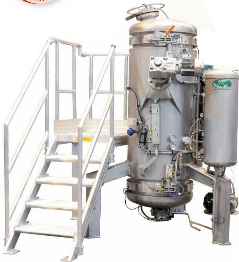
Los residuos contaminados se cargan en la cámara superior donde una trituradora industrial reduce los desechos en trozos pequeños. Usando la gravedad, el material procesado cae en la cámara de tratamiento inferior.
