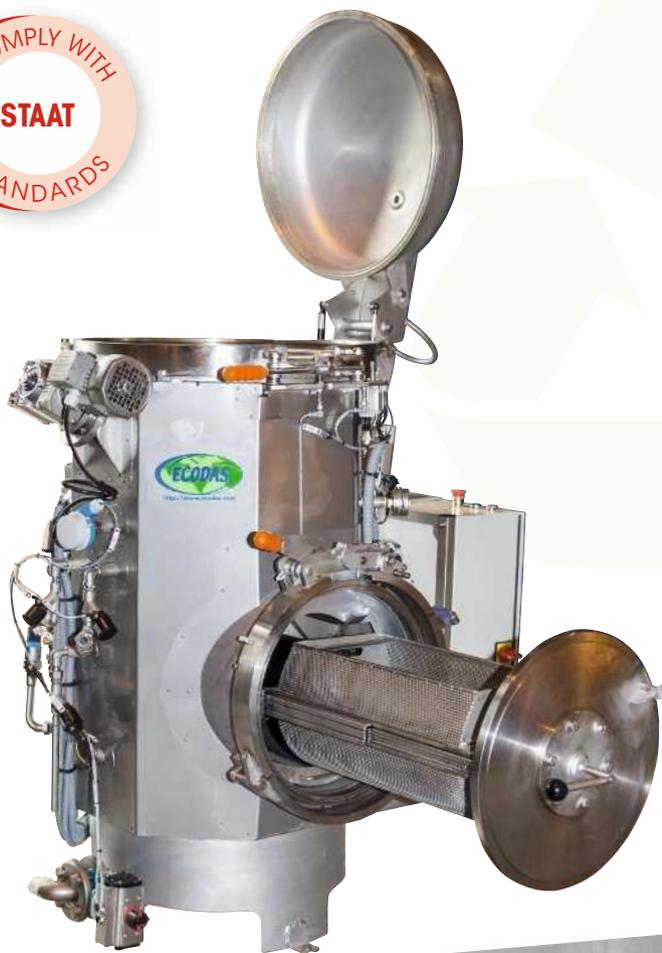
Nuestro proceso patentado está diseñado para **triturar y esterilizar los desechos infecciosos** mediante vapor saturado. El triturado y la esterilización se realizan en un sistema totalmente cerrado y automatizado, de acero inoxidable, sin manipulación intermedia de los residuos.
